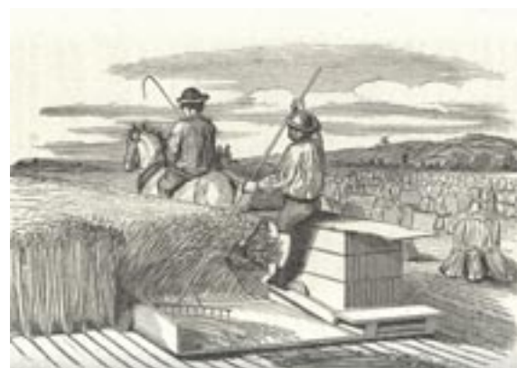
Moissonneuse batteuse fonctionnant avec la force du cheval. A. Jourdiar, Le matériel agricole , Paris, Hachette et Cie, 1856.
