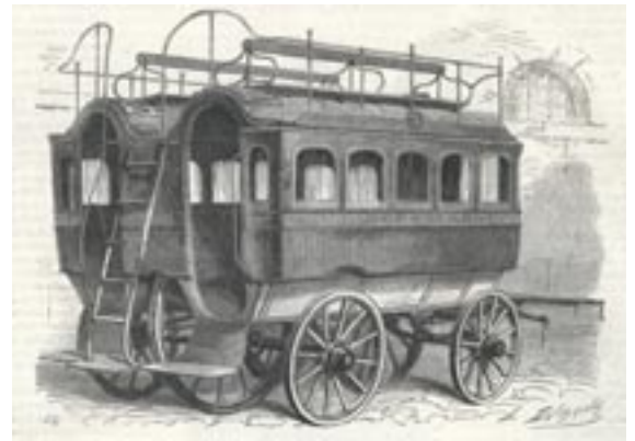
Omnibus de 56 places porté par six roues, appelé bitricycle, à deux compartiments latéraux, construit par M.J. Audineau.
