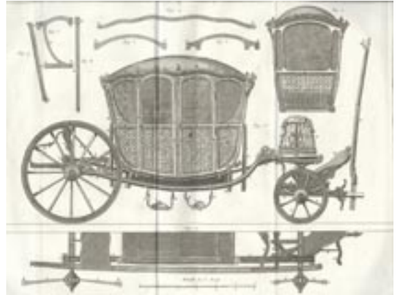
Plans d'une berline de voyage à 4 portières L'Encyclopédie ou Recueil des planches sur les sciences, les arts libéraux et les arts mécaniques , Paris, Brisson, 1771, 9 volumes, Tome IX, article "sellier-carrossier" planche VII.
